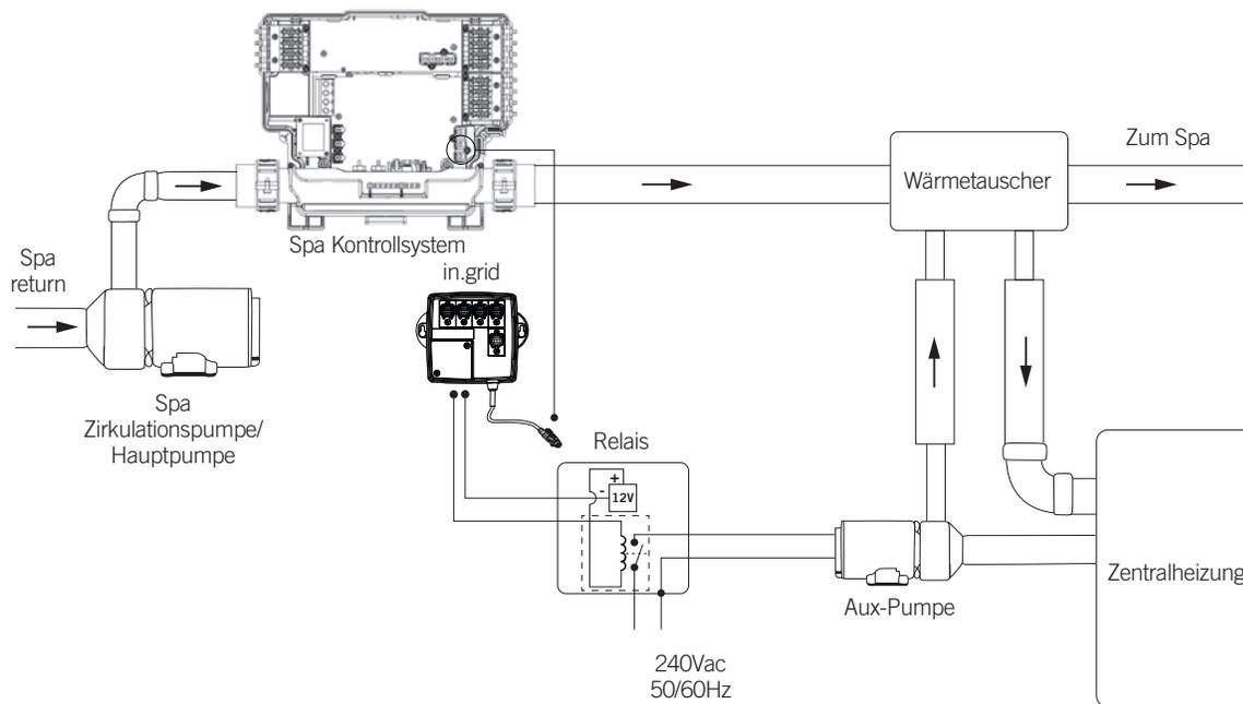
Bitte stellen Sie sicher, dass Ihr Wärmeaustausch keine Durchflussbegrenzung hat. Die Heizung in Ihrem Spa-Steuersystem der Y-Serie benötigt ständig mindestens 20 GPM (75 L/min).
